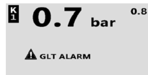
Abb. 3 Anzeige Alarm nach der GLT-Verzögerung
