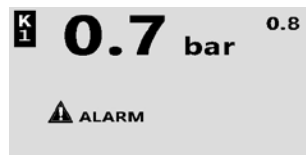
Abb. 2 Anzeige Alarm innerhalb der GLT-Verzögerung
